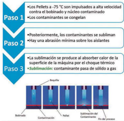
Figura 4. Explicación del proceso de limpieza criogénica.
